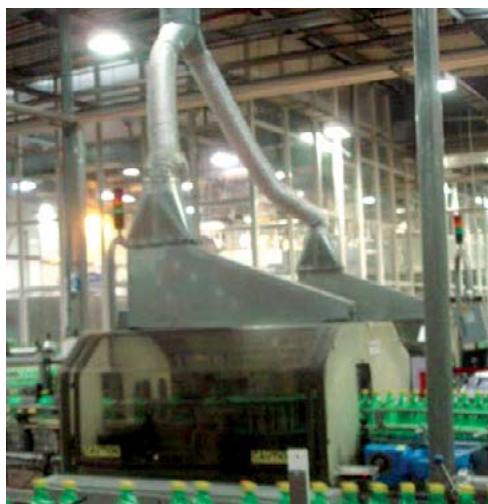
Fot. 11 i Fot. 12. Instalacje wyciągowe nadmiaru ciepła i oparów produkcyjnych z urządzeń pakujących i procesowych. Źródło: fotografie ze zbiorów autora.
