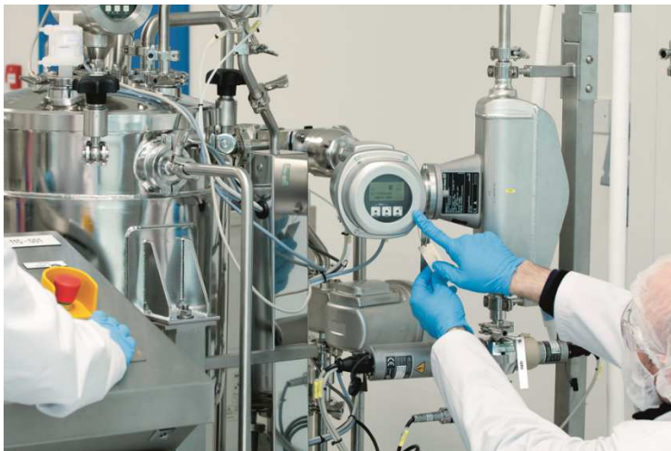
Ciągły pomiar zawartości ekstraktu w °Plato przepływomierzem masowym Promass
